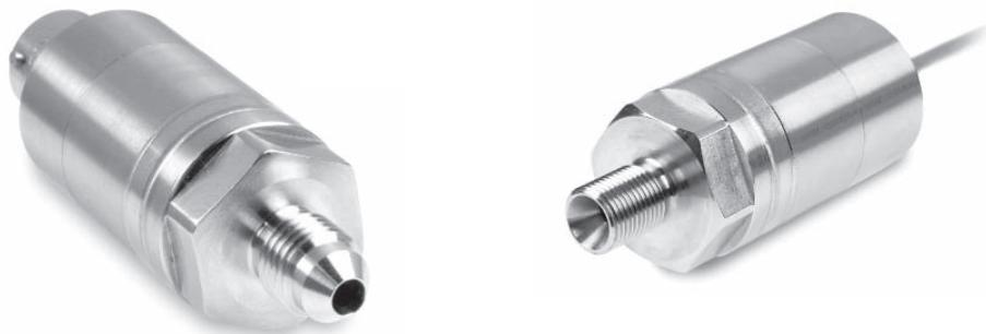
317 是一款专门为各种发动机测试应用设计的传感器，非常适合在极限温度、振动和冲击的场合使用。硅敏感元件使用 316L 不锈钢和哈氏合金隔离，具有极强的介质兼容性，同时具有抗高过压和压力冲击的能力。
