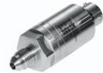
PDCR 330 是 GE Druck 工程师团队近 10 年开发的顶级压力传感器，该产品普遍用于航空项目而且其具有飞行器认证资格同时适用于飞行器实验台。其压力测量范围为 35KPa – 70MPa 的表压，绝压。该产品外壳为不锈钢以及哈氏合金，由一个耐高压的玻璃-金属封装以及精确的电子束焊接保证其具有极高的耐压值，该传感器使用微机械技术将测量与补偿电路集成在同块硅芯片，从而使传感器获得了出色的长期稳定性以及在宽温度条件下良好的特性。
